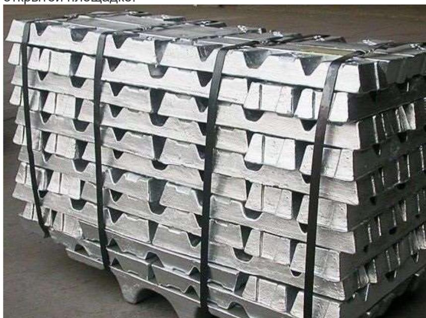
При повышенной влажности на поверхности образуется пленка, которая эффективно защищает чушки от коррозии.
