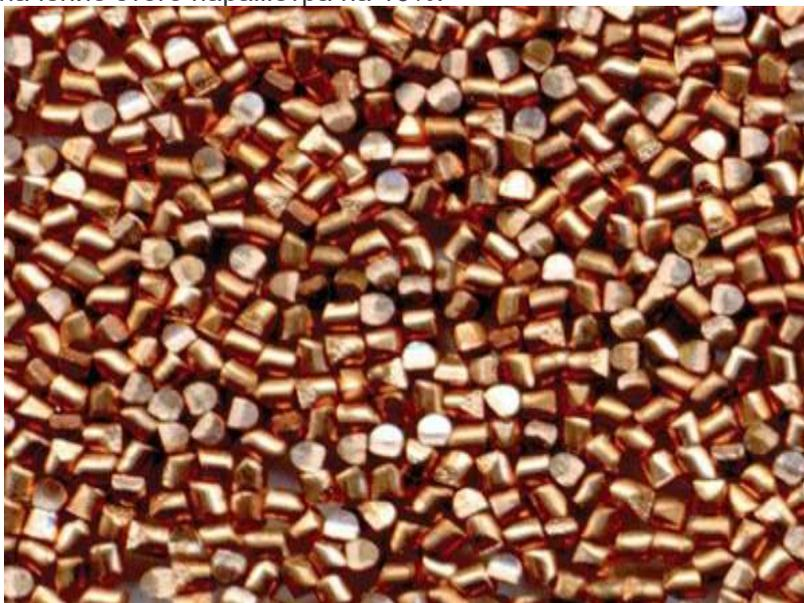
По своей форме медный анод бывает шарообразным, цилиндрическим или в виде пластины. Форма во многом определяет отличия этой продукции по некоторым характеристикам. Так, например, первый вид позволяет осуществлять процесс нанесения покрытия при высокой плотности тока на постоянных технологических режимах. В результате анодная медь используется, практически, полностью и получается беспористое металло-кристаллическое покрытие.
