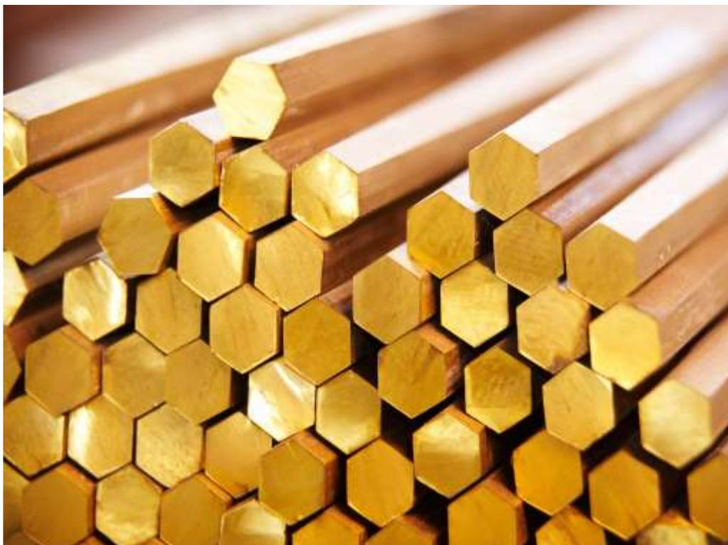
Латунный шестигранник является полуфабрикатом, из которого производятся гайки, болты, детали трубопроводной арматуры, полиграфических матриц. Так же, как и бронзовый шестигранник, он нашёл широкое применение в изготовлении декоративных конструкций. Кроме того, без него не обходятся такие отрасли промышленности, как судостроение, гидроэнергетика, электротехника, машиностроение, строительство.
