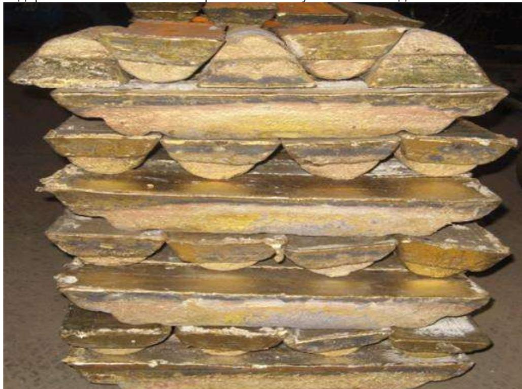
Форма конечного изделия (плоская, шестиугольная, круглая, квадратная, «чушковая») задаётся при помощи изложниц соответствующих геометрических размеров. Поверхность крупных (а иногда и мелких) слитков содержит пережимные линии, делящих изделие на несколько равных частей.
